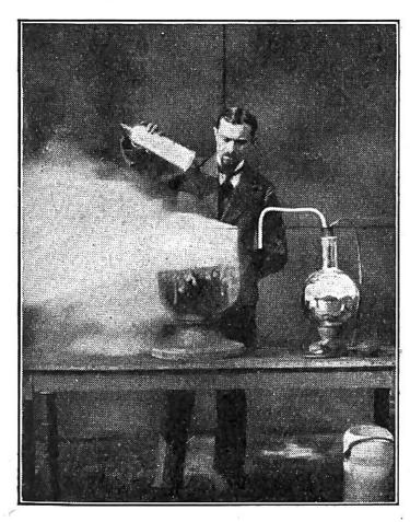
Versuch mit flüssiger Luft. Diese wird in ein Gefäss mit Wasser geschüttet, wobei sich mächtig Dampf entwickelt.
