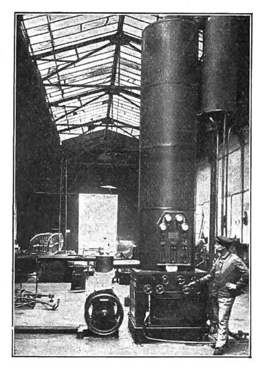
Ein Apparat, der in der Stunde 60 m³ flüssige. Luft herstellt, was unter Anwendung grösster Kälte und hohem Druck geschieht.
