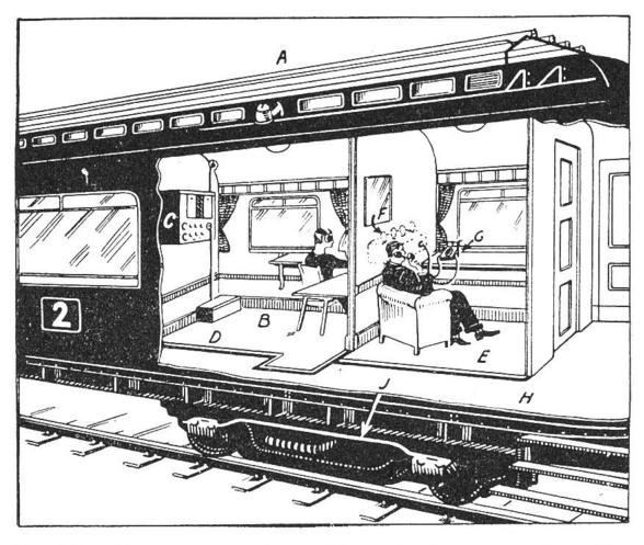
Radio-Telephon im Eisenbahnzug. A = Zugantenne. B = Zugamt. C = Sender. D = schalldichte Samtpolsterung. E = Sprechzelle. F = Empfänger. G = Tischtelephon. H = Seitengang des Wagens. J = Erdung der Zugsprechstelle.
