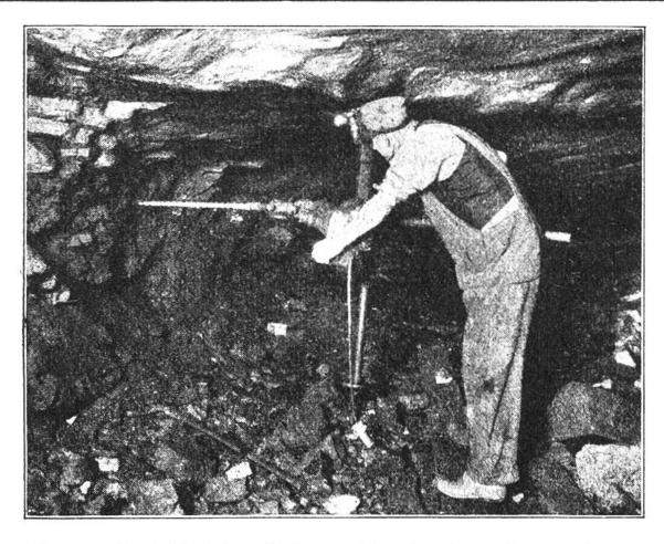
Mineur mit elektrischer Bohrmaschine in einem Bergwerk von Pennsylvania (Vereinigte Staaten von Nordamerika). Die Bohrlöcher werden mit Sprengstoff gefüllt, der, mit elektrischer Zündschnur zur Explosion gebracht, die Kohle losbricht.
