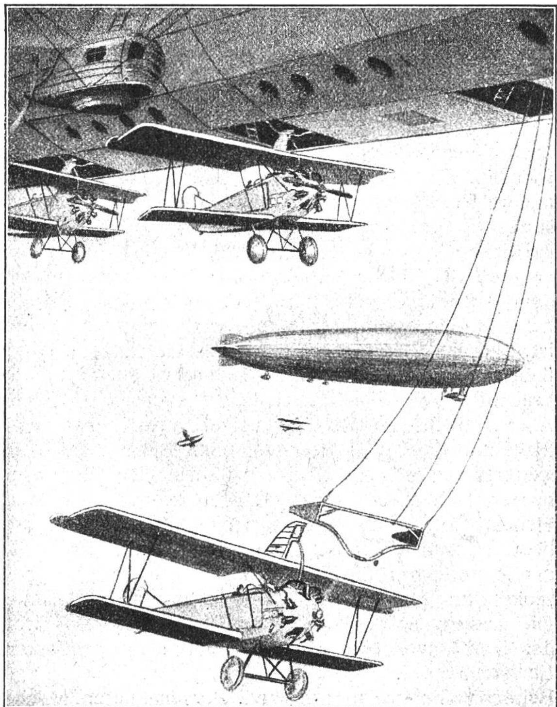
Landevorrichtung für Flugzeuge an der Unterseite von Luftschiffen. Das Luftschiff „Los Angeles“ nimmt in voller Fahrt ein Flugzeug „an Bord“. Zwei andere haben sich schon oben eingehängt.
