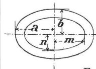
Halbe Achsen der äussern Ellipse=a,b, Halbe Achsen der innern Ellipse=m,n, Fläche: F = N.(ab-mn).
