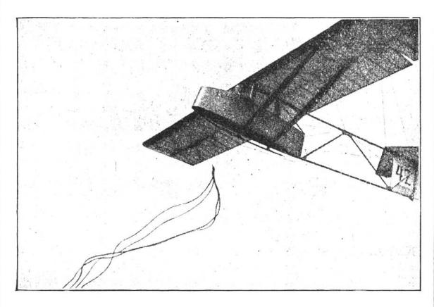
Das Segelflugzeug wird mittels Gummiseilen in die Luft hochgeschnellt.
