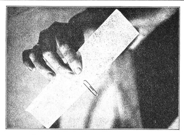
Ein Gleitflieger aus einem Stück Papier, der vorn mit einer Bureauklammer beschwert, hinten, zur Höhensteuerung, hochgebogen ist. Über dem warmen Ofen bringt die aufwärts strömende Luft den "Flieger" aus dem Gleiten ins Steigen, ins Segeln.
