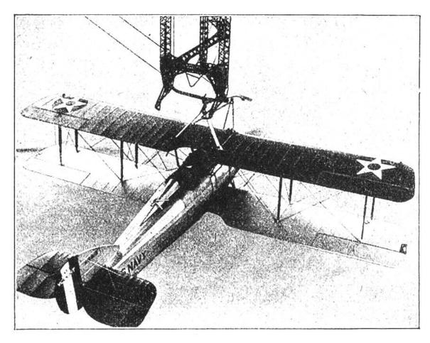
Es ist gelungen. Der Flieger hat sein Flugzeug am "Landungssteg" eingehängt; es wird heraufgehoben und in der "Garage" des Luftschiffes, wo Platz für fünf Flugzeuge vorhanden ist, versorgt.
