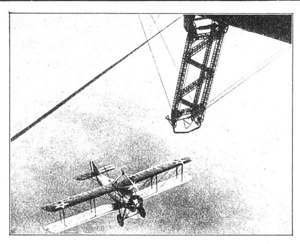
Luftschiff und Flugzeug haben sich auf gleich schnelle Fahrt eingestellt. Sie scheinen gegeneinander stille zu stehen. Das Luftschiff hat den "Landungssteg" herabgelassen, der zu unterst eine Querstange trägt. Das Flugzeug versucht während der Fahrt mit einem oben angebrachten Haken sich an der Querstange einzuhängen.
