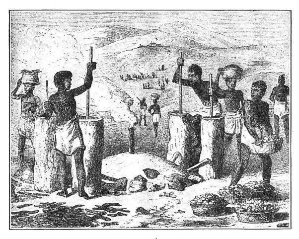
Die einfachste Form des Hochofens: Eisenschmelze in Afrika. Vier Blasbälge, hergestellt aus gehöhlten Baumstämmen, fördern die Glut, in der das Eisen durch Schmelzen von dem ihm anhaftenden Gestein gesondert wird.
