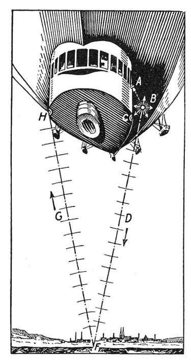
zen bei Landungen nicht gross. Das Barometer kann z. B. 300 Meter Höhe angeben, indes das Luftfahrzeug vielleicht nur einige Meter über einem Hügel dahingleitet, der eben 300 m aus einem Tal ansteigt. Diese Lotapparate für Flugzeuge rechnen natürlich mit der Schallgeschwindigkeit in der Luft, die 333 m in einer Sekunde beträgt.
