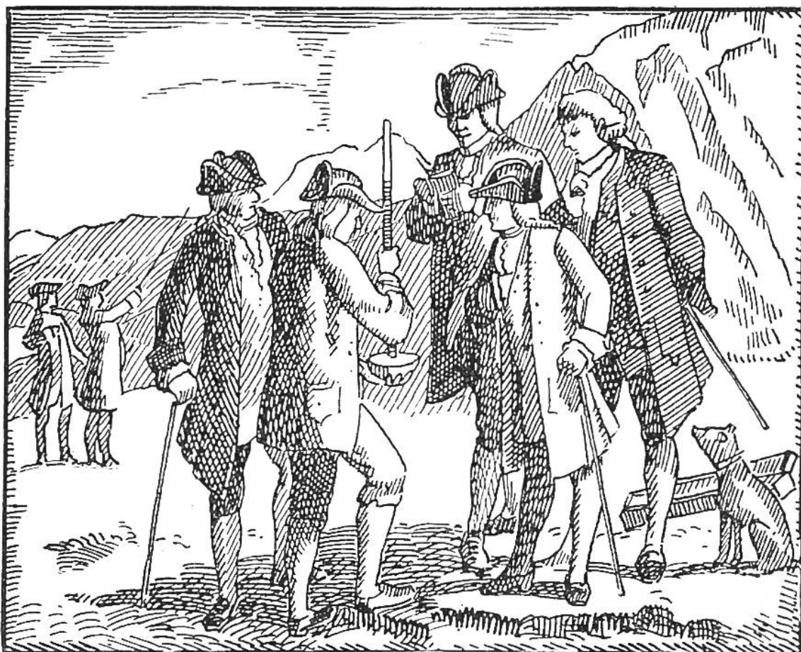
Périers Versuch mit der Torricellischen Röhre (am 20. Sept. 1648 auf dem Puy de Dôme) zum Nachweis der Abnahme des Luftdrucks in der Höhe. Périer misst die Höhe der Quecksilbersäule.
