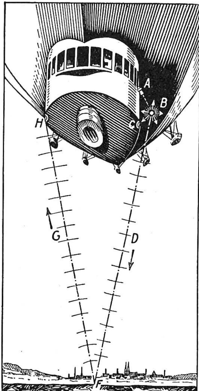
zen bei Landungen nicht gross. Das Barometer kann z. B. 300 Meter Höhe angeben, indes das Luftfahrzeug vielleicht nur einige Meter über einem Hügel dahingleitet, der eben 300 m aus einem Tal ansteigt. Diese Lotapparate für Flugzeuge rechnen natürlich mit der Schallgeschwindigkeit in der Luft, die 333 m in einer Sekunde beträgt.
