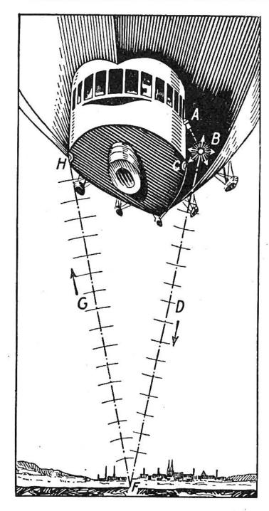
zen bei Landungen nicht gross. Das Barometer kann z. B. 300 Meter Höhe angeben, indes das Luftfahrzeug vielleicht nur einige Meter über einem Hügel dahingleitet, der eben 300 m aus einem Tal ansteigt. Lotapparate Diese für Flugzeuge rechnen natürlich mit der Schallgeschwindigkeit in der Luft, die 333 m in einer Sekunde beträgt.
