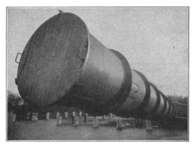
Eine "Riesenkanone", mit welcher der Sterngucker Blicke auf ferne Sternenwelten "schiesst": das mit Deckel geschlossene Fernrohr der Sternwarte Berlin-Treptow. Das Rohr, eines der grössten in Europa, ist 21 m lang bei einem Durchmesser von 1,40 m.
