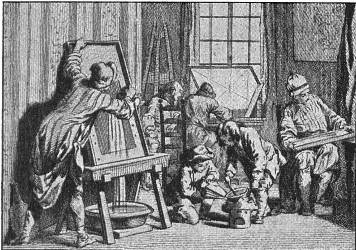
Die Kupferstecher (1). „Stiche“ sind Bilder, die auf eine Metallplatte gezeichnet und dann gedruckt werden. Die Platte wird zunächst mit Hilfe von Sandstein und Wasser poliert (Arbeiter links), dann mit einer dünnen Harzschicht überzogen. Die Lehrbuben (Mitte) erwärmen das Harz.
