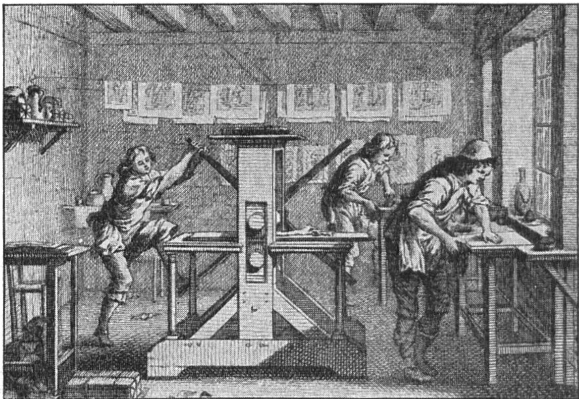
Die Kupferstecher (3). Die in die Platte eingeätzten Linien werden mit Farbe ausgefüllt, und die Platte kommt in die Handpresse, wo der Abdruck auf Papier erfolgt. — Unsere Bilder sind Wiedergaben von Stichen aus d. J. 1745. Das Arbeitsverfahren des Kupferstechers ist noch heute im Prinzip das gleiche.
