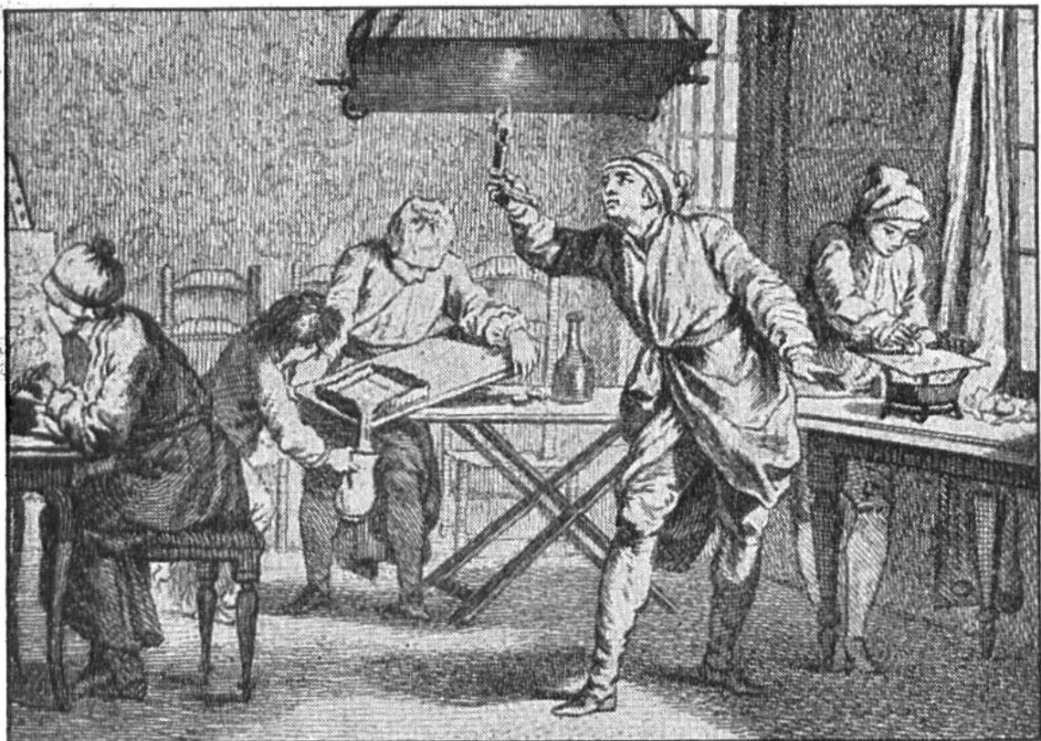
Die Kupferstecher (2). Die Harzschicht auf der Platte wird mit dem Russ einer Kerze geschwärzt. Der Zeichner ritzt jetzt die Zeichnung mit einem Metallstift auf die Platte. Die Striche dringen durch die Harzschicht auf das Kupfer. Eine jetzt über die Platte gegossene Säure ätzt die ganze Zeichnung in die Platte ein. — Ein Arbeiter giesst die Säure ab (Bildmitte), ein anderer (rechts) entfernt das Harz völlig von der Platte.
