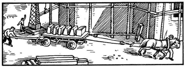
Weil nur ein Pferd zum Weitertransport zur Verfügung steht, hilft sich der Fuhrmann, indem er zwei lose Rollen gebraucht. Dadurch ist nur der vierte Teil der Kraft nötig.
