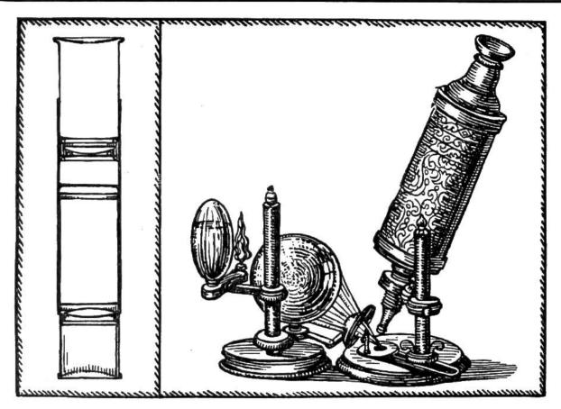
Links: Erstes Mikroskop der holländischen Brillenmacher Janssen aus dem Jahre 1590. Rechts: Mikroskop des Engländers Hooke aus dem Jahre 1665 mit Beleuchtungsapparat.
