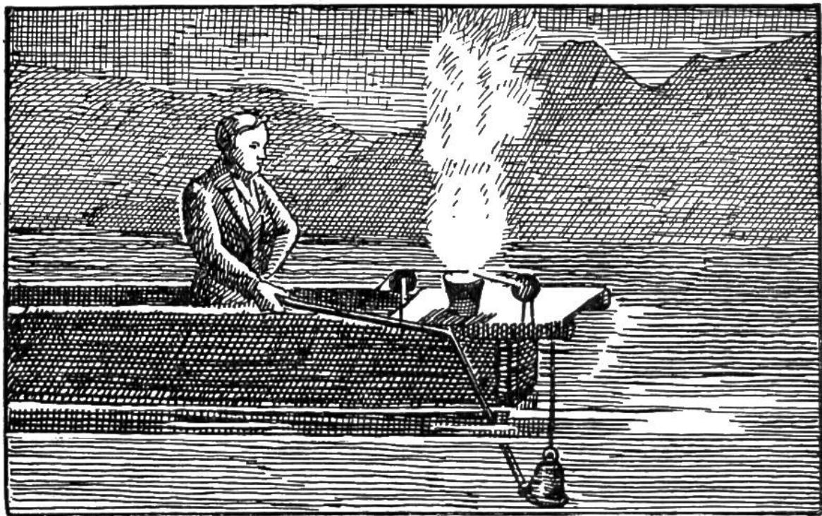
Messung der Fortpflanzungsgeschwindigkeit des Schalles im Wasser, ausgeführt durch Colladon und Sturm im Jahre 1827 auf dem Genfersee. Sturm gibt das Glockenzeichen; im gleichen Augenblick entzündet sich Pulver und flammt auf.
