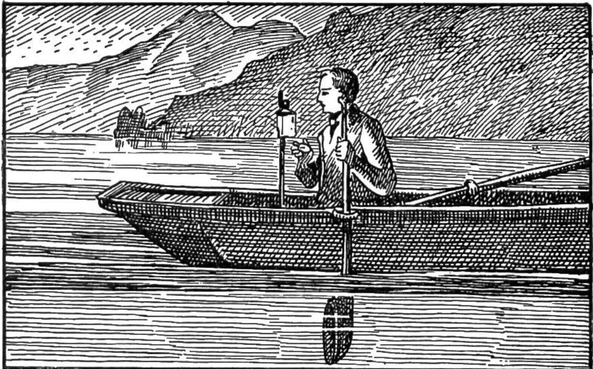
Messung der Fortpflanzungsgeschwindigkeit des Schalles im Wasser. Colladon sieht den Lichtblitz des entzündeten Pulvers und wartet bis er das Glockenzeichen, das sich im Wasser fortpflanzt, im Hörrohr wahrnimmt. Die beiden Zeiten liest er auf einem Chronometer ab.
