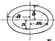
Elliptischer Ring: Halbe Achsen der äussern Ellipse=a,b, Halbe Achsen der innern Ellipse=m,1, Fläche: F = T.(ab-mn).
