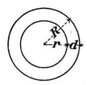
Aeusserer Radius = R. Innerer Radius = r,  $F = R^2 \pi - r^2 \pi$ . =  $\pi(R+r) \cdot (R-r)$ . roenn d = radiale Breite des Kreisrings so ist  $F = \pi(2r+d)$ . d
