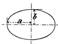
Ellipse: Halbe grosse Achse = a, Halbe Kleine Achse = b, Fläche F = a.b. T.
