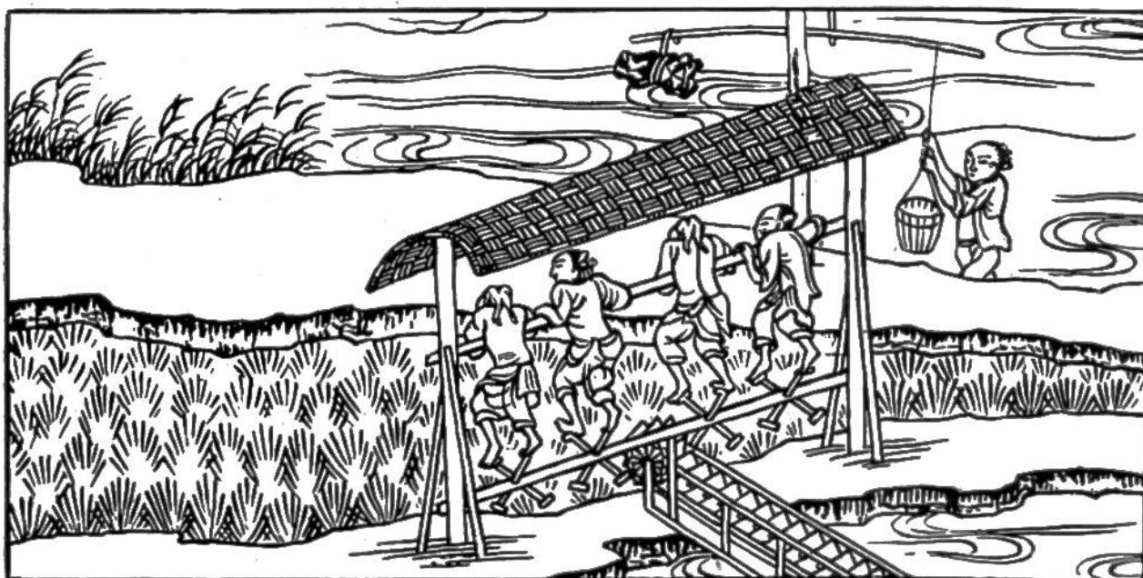
**Das Bewässern.** Wenn das Unkraut entfernt ist und das Feld zu vertrocknen droht, wird der Pflanzung reichlich Wasser zugeführt. In wenig Tagen stehen dann die Reisähren in üppigem Wachstum in der schlammigen Erde. Erfinderisch waren die Chinesen in Vorrichtungen zum Wasserschöpfen. Unser Bild zeigt ein endloses, durch Treten bewegtes Schöpfband.
