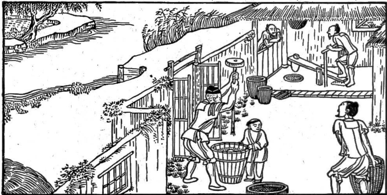
**Das Stampfen.** Um die Reiskörner von der Hülse zu befreien, werden sie in kübelartige Gefäße geschüttet und mit Kolben gestampft. Das Bild zeigt auch einen mit dem Fusse gehobenen Fallhammer, der zu gleichem Zwecke dient; auch Wasserkraft wird dazu benutzt.
