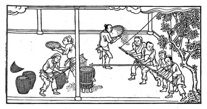
Das Enthülsen. Die Reiskörner werden in der Enthülsungsmühle mit Stangen, die hin und her gezogen werden, von den Hülsen befreit, ohne dass das Korn beschädigt wird. Durch Sieben und durch Aufwerfen im Winde (Worfeln) wird das Reiskorn von der Spreu gesondert.
