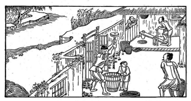
Das Stampfen. Um die Reiskörner von der Hülse zu befreien, werden sie in kübelartige Gefässe geschüttet und mit Kolben gestampft. Das Bild zeigt auch einen mit dem Fusse gehobenen Fallhammer, der zu gleichem Zwecke dient; auch Wasserkraft wird dazu benutzt.
