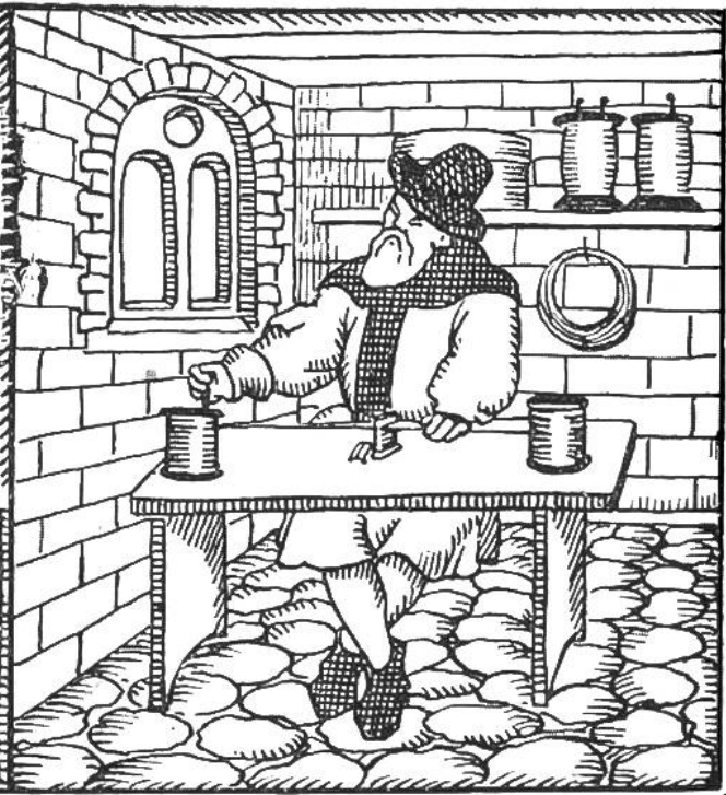
Drahtziehen mit zwei Rol- len „Leiern“, um 1527.
