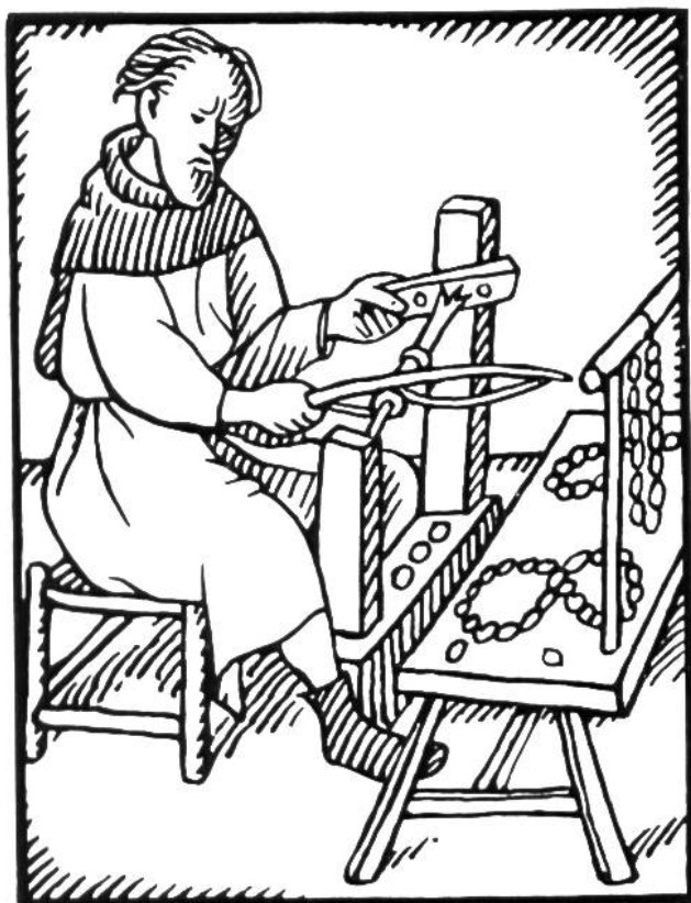
Siedelbohrer, mit dem man die Kügelchen des Rosenkranzes aus dem Holz heraus bohrte. (Nach einer Zeichnung aus dem Jahr 1390.)
