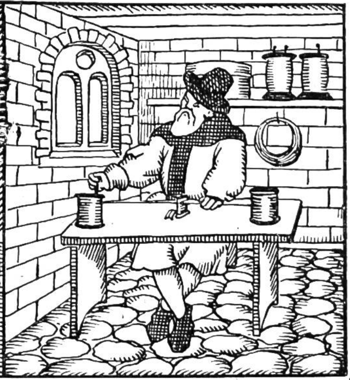
Drahtziehen mit zwei Rol- len „Leiern“, um 1527.
