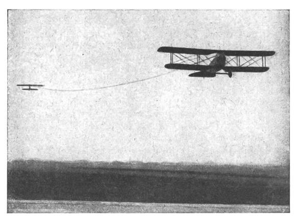
Der fliegende "Zug". Durch ein 100 Meter langes Drahtseil ist das Segelflugzeug mit dem Motorflugzeug vers bunden. In einer höhe von einigen hundert Metern wird das Kabel gelöst. Das von einem klieger gesteuerte Segelflugs zeug sentt sich langsam, den Platz umtreisend, auf den Boden.
