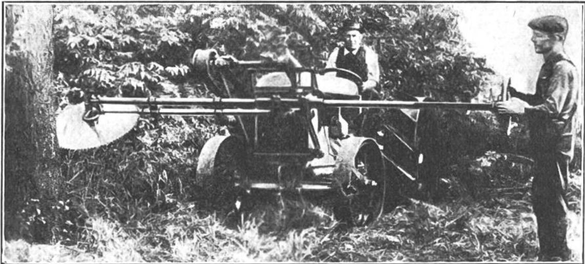
Die Motorkraft des Suhrwerkes wird auf die Säge übertragen und durch ein Handrad gesteuert.
