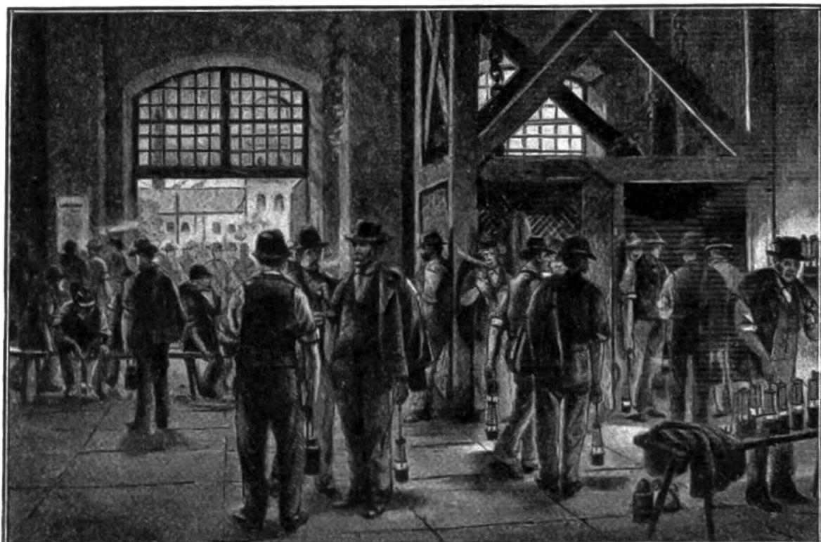
In einem modernen Kohlenbergwerk, Einfahrt zur Schicht. Rechts hinten betreten die Arbeiter den Förderkorb, eine Art Aufzug, der die Bergleute nach den Abbaumassen und von dort wieder zurückbringt. Die Grubenlampen sind mit feinem Drahtgeflecht umgeben, das die Entzündung von Grubengasen verhindert.
