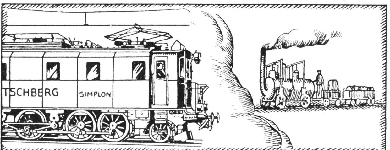
1825 wurde die erste Eisenbahn (Stockton-Darlington in England) eröffnet, mit kleiner, verbesserter Dampflokomotive von Stephenson. Lötschberg-Lokomotiven mit Elektromotoren von 2500 PS sind Riesen dagegen.
