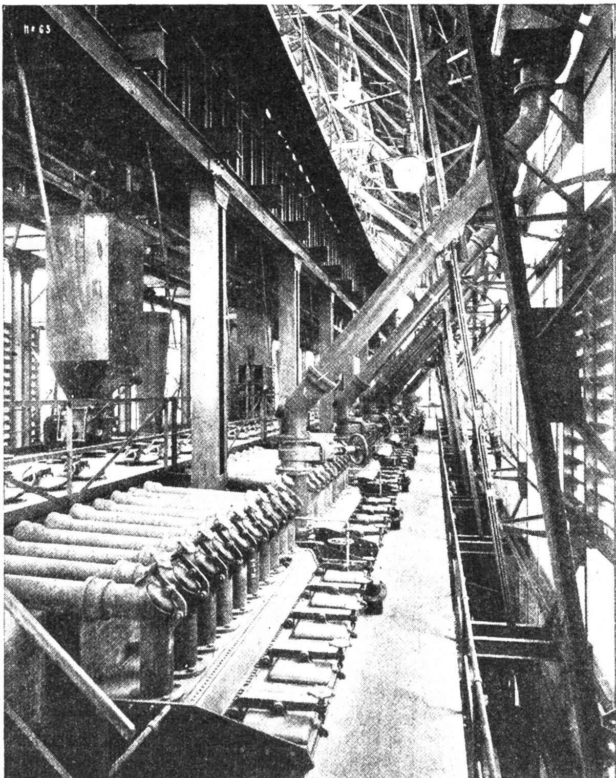
Blick in ein modernes Gaswerk. Aus den senkrecht eingebauten Öfen strömt das rohe Gas nach den Kühl- und Reinigungsapparaten.
