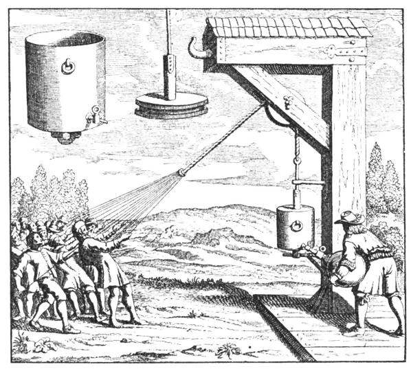
50 Männer konnten nicht verhindern, daß der Kolben unter dem Drud der äußern Luft in den luftleeren Zylinder hineingestoßen wurde.
