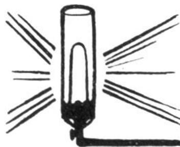
1885. Auer von Welsbach erfindet das Gasglühlicht, das eine Umwälzung in der Gasbeleuchtung bedeutet. Der Auerbrenner vermischt das Leuchtgas mit Luft
