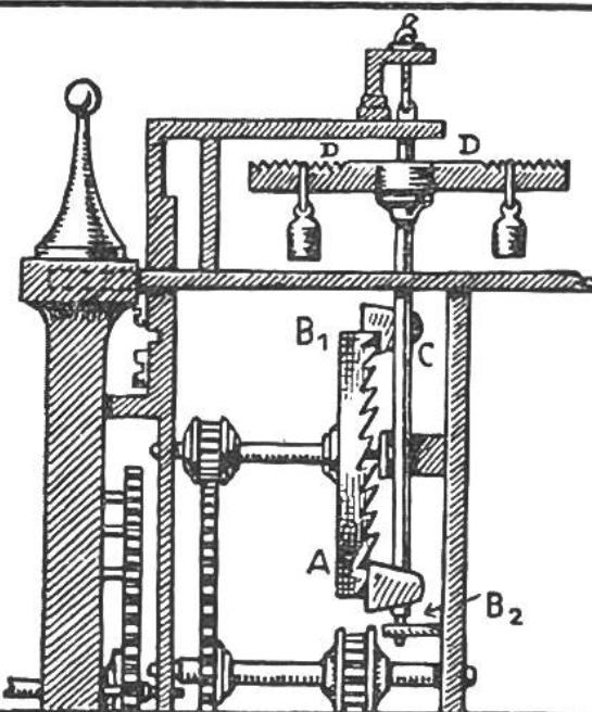
Das abrollende Gewicht an der Räderuhr würde ohne Hemmung das Laufwerk in einem Zuge abhaspeln. Um den Gang zu verlangsamen und regelmäßig zu gestalten, war ein Regulator notwendig. Zu diesem Zwecke benutzte man damals die sogenannte Spindelhemmung; das Zahnrad A ergreift abwechselungsweise die Flügel B 1 und B 2 der Achse C u. dreht dadurch die mit kleinen Gewichten beladene Wage D hin und her, so daß eine gewisse Gleichmäßigkeit in den Gang der Räder kommt.
