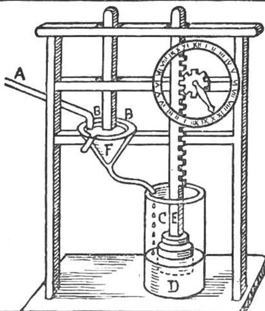
Eine große Vervollkommnung brachte die schon 300 Jahre v. Chr. in Ägypten gebräuchliche Wasseruhr. Bei dieser fließt das Wasser von der Röhre A durch den Trichter B nach dem Zylinder C. Die Schwimmkraft des Kolbens D hebt die Stange E, welche durch eine Zahnradvorrichtung den Zeiger auf dem Zifferblatte dreht. Durch die Verstellung des Kegels F konnte die Wasserzufuhr verändert werden, um der Tages- und Nachtlänge je nach Jahreszeit Rechnung zu tragen.
