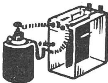
1836. Der Livländer Jacobi erfindet die Galvanoplastik, elektrochemische Zersetzung mit Niederschlag von Metall, wodurch Nachbildungen in Metall und Überzüge (Versilbern, Verkupfern, Vernittern) ausgeführt werden können.
