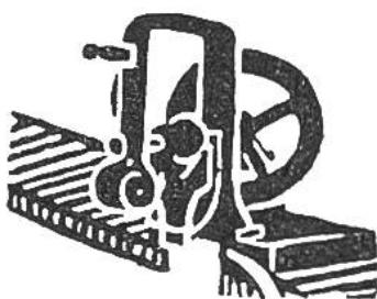
1846. Nachdem 100 Jahre lang von vielen Erfindern Versuche zum Bau von Nähmaschinen gemacht worden waren, konstruierte der Amerikaner Elias Howe die erste wirklich brauchbare Nähmaschine. Er ging von den Arbeiten Hunts und Thimonniers aus und erfand die Nadel mit dem Ohr an der Spitze, und die Anwendung des Schiffchens.
