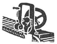
1846. Nachdem 100 Jahre lang von vielen Erfindern Dersuche zum Bau von Nähmaschinen gemacht worden waren, konstruierte der Amerikaner Elias howe die erste wirklich brauchbare Nähma=5 chine. Er ging von den Arbeisten hunts und Thimonniers aus und erfand die Nadel mit dem Öhr an der Spike, und die Answendung des Schiffchens.
