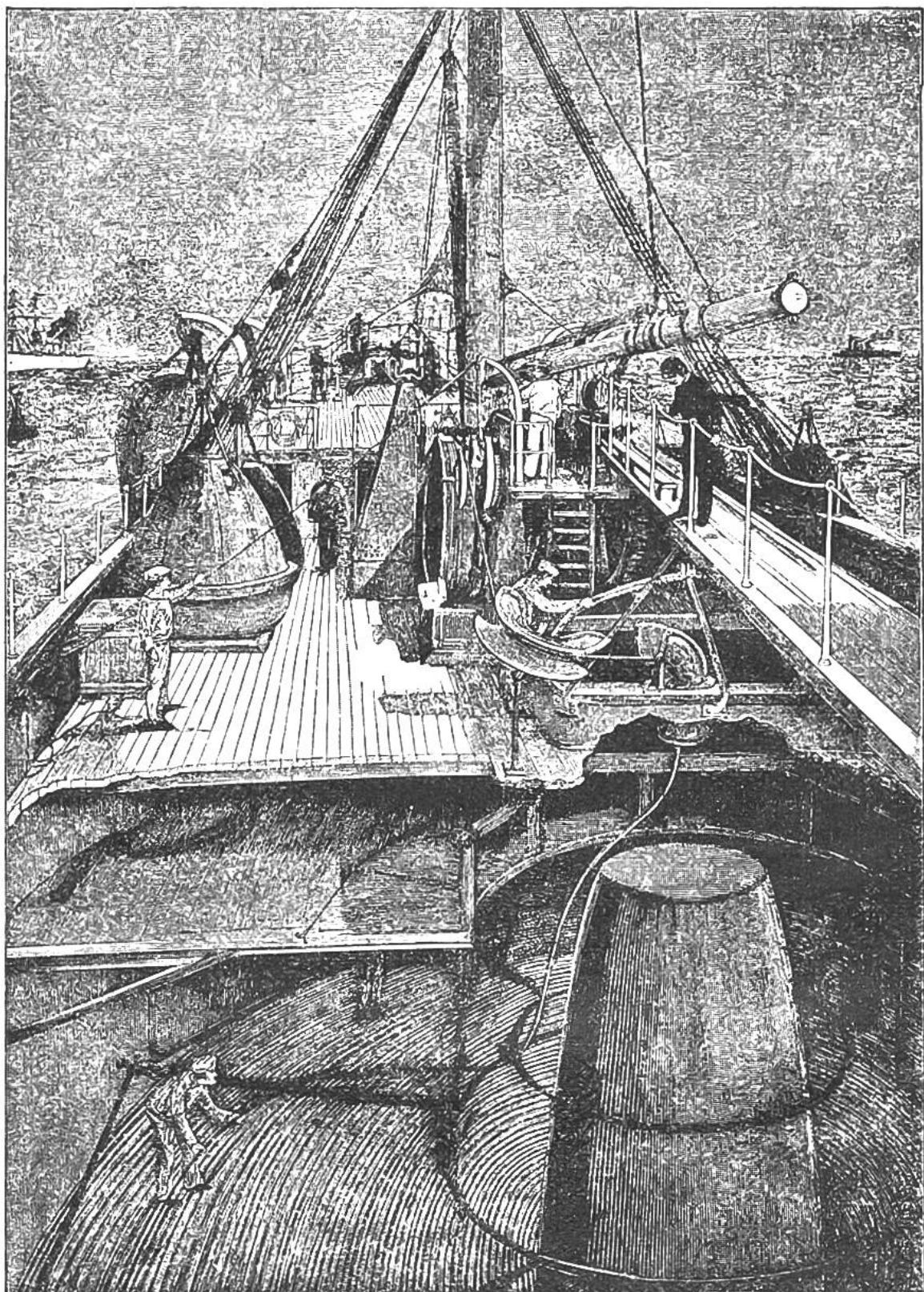
Innenraum eines Kabelschiffes. Auf dem Boden unten im Schiff liegt das Kabel aufgerollt; durch eine Luke wird es auf Deck gezogen (wo es über verschiedene maschinelle Vorrichtungen läuft) und zuletzt durch eine sinnreiche Auslegemaschine auf den Meeresboden versenkt.
