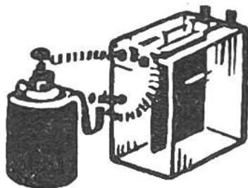
1836. Der Livländer Jacobi erfindet die Galvanoplastik, elektrochemische Zersetzung mit Niederschlag von Metall, wodurch Nachbildungen in Metall und Überzüge (Versilbern, Verkupfern, Vernittern) ausgeführt werden können.
