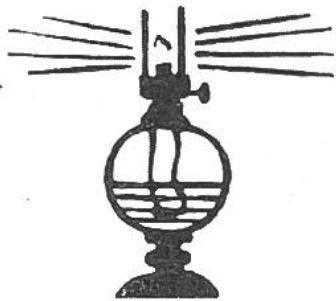
1855. Petrol Lampe von dem Amerikaner Silliman erfunden. 1782 erfand Argand von Genf an Stelle des gewöhnlichen Dochtes den bewährten freisförmigen Brenner mit innerer Luftzufuhr.
