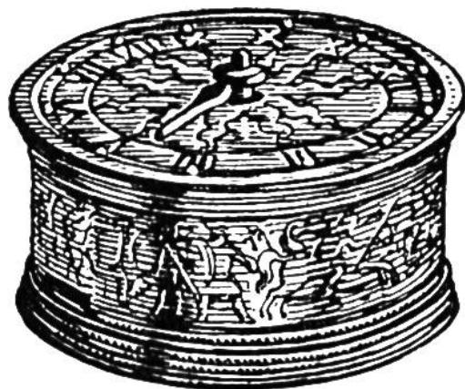
Kleine Tischuhren mit Räderwerk gab es schon zu Ende des 15. Jahrhunderts. Sie bestanden gewöhnlich aus einem bronzenen Gehäuse, welches das ganz aus Eisen gefertigte Werk umschloß. Da das Zuggewicht der großen, senkrecht stehenden Räderuhren bei flach liegenden Tischuhren nicht verwendet werden konnte, benutzte man an seiner Stelle spiralförmig gewundene Federn, welche das Werk vermöge ihrer Spannkraft im Gang hielten.
