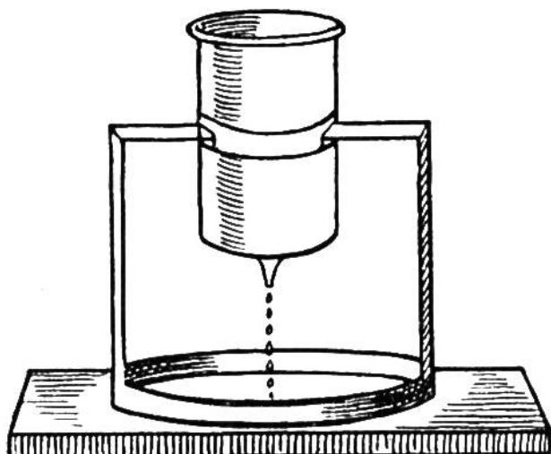
Eine ähnliche, primitive Art, den Zeitablauf zu messen, war folgende: Statt das Wasser in ein Becken einzufüllen zu lassen, füllte man einen Behälter damit und ließ die Flüssigkeit durch ein enges Röhrchen langsam abtropfen. Die gleiche Menge Wasser läuft stets in derselben Zeit ab und ermöglicht auf diese Weise eine ungefähre Einteilung. Zur Zeit des Königs Assurbanipal, 640 Jahre vor Christus, benützten die Assyrer Wasseruhren dieser Art, ebenso andere Völker.
