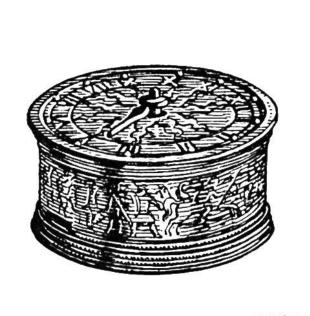
Kleine Tischuhren mit Räderswerk gab es schon zu Ende des 15. Jahrhunderts. Sie bestanden gewöhnlich aus einem bronzenen Gehäuse, welches das ganz aus Eisen gefertigte Werk umschloß. Da das Zuggewicht der großen, senkrecht stehenden Räderuhren bei flach liegenden Tischuhren nicht verwendet werden konnte, benutte man an seiner Stelle spiralförmig gewundene Sedern, welche das Werk vermöge ihrer Spannkraft im Gang hielten.
