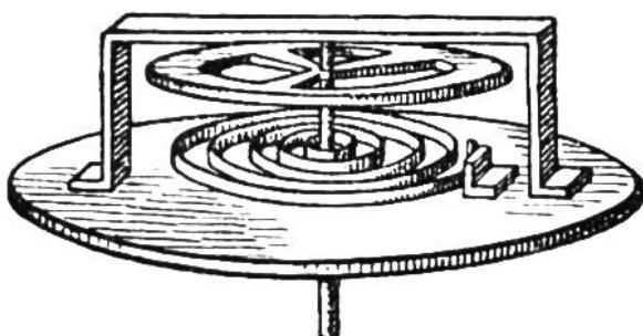
Der Regulator besteht aus einer feinen Spiralfeder mit „Schwungrad“ (Balancier). Das eine Ende der Feder ist an der Achse des Rades, das andere auf der Grundplatte befestigt. Dreht man das Schwungrad so, daß die Spiralfeder gespannt wird, so hat diese das Bestreben, wieder in die ursprüngliche Lage zurückzuschwingen, geht aber infolge der Elastizität darüber hinaus und wieder zurück und vollführt so, das Schwungrad mitführend, die gleichen regelmäßigen Schwingungen wie das Pendel.
