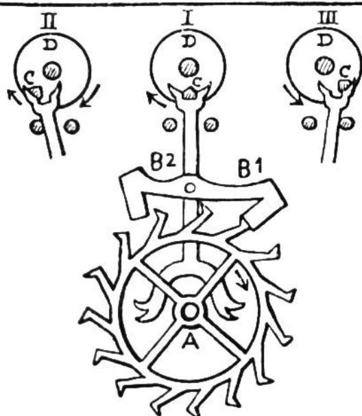
Ähnlich wie bei der Pendeluhr drücken die Zähne des Rades A auf den Ankerarm B 1; der Anker greift in den Zapfen C, dreht die „Unruhe“ D nach links, spannt dadurch die Spiralfeder und läßt gleichzeitig den Arm B 2 hemmend in das Rad A eingreifen. Die gespannte Feder treibt die „Unruhe“ sofort wieder nach rechts, wobei der Zapfen C die Hemmung des Ankerarmes B 2 löst; ein Zahn schlüpft durch, gleich wird aber das Rad A von neuem durch den eingreifenden Arm B 1 gehemmt usw.
