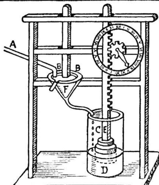
Eine große Vervollkommenung brachte die schon 300 Jahre v. Chr. in Ägypten gebräuchliche Wasseruhr. Bei dieser fließt das Wasser von der Röhre A durch den Trichter B nach dem Zylinder C. Die Schwimmkraft des Kolbens D hebt die Stange E, welche durch eine Zahnradvorrichtung den Zeiger auf dem Zifferblatte dreht. Durch die Verstellung des Kegels F konnte die Wasserzufluhr verändert werden, um der Tages- und Nachtänge je nach Jahreszeit Rechnung zu tragen.
