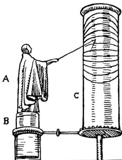
Ebenso arbeitete eine andere Wasseruhr; sie trug statt der Zahnradstange eine kleine Figur A auf dem Schwimmkolben B, die mit einem Stabe auf den Zylinder C hinwies, welcher die Zeiteinteilung trug. Der aufsteigende Kolben drehte durch Zahnradübertragung den Zylinder einmal im Jahre herum und ermöglichte es, daß im Sommer die breitere, im Winter die schmalere Seite der Stundenringe zu sehen war; so wurde die Uhr den verschiedenen Tageslängen angepaßt.
