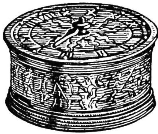
Kleine Tischuhren mit Räderwerk gab es schon zu Ende des 15. Jahrhunderts. Sie bestanden gewöhnlich aus einem bronzenen Gehäuse, welches das ganz aus Eisen gefertigte Werk umschloß. Da das Zuggewicht der großen, senkrecht stehenden Räderuhren bei flach liegenden Tischuhren nicht verwendet werden konnte, benutzte man an seiner Stelle spiralförmig gewundene Federn, welche das Werk vermöge ihrer Spannkraft im Gang hielten.
