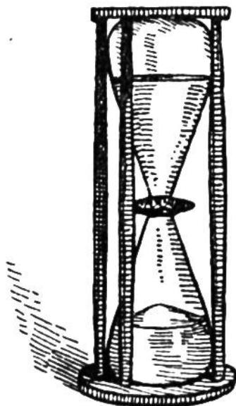
Bis weit über das Mittelalter hinaus verwendete man die Sanduhr hauptsächlich im Hausgebrauch. Aus dem oberen Teile eines Glasgefäßes fällt durch ein enges Loch feiner Sand in den untern Teil. Sobald aller Sand durchgerieselt ist, wird das Gefäß umgedreht, der Vorgang wiederholt sich, und zwar immer in der gleichen Spanne Zeit. Sanduhren mit 4 Gefäßen statt nur einem ermöglichen es, den Ablauf von  $\frac{1}{4}$ ,  $\frac{1}{3}$ ,  $\frac{3}{4}$  und 1 Stunde zu bestimmen.
