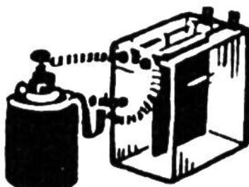
1836. Der Civländer Jacobi erfindet die Galvanoplastik, elektrochemische Zersetzung mit Niederschlag von Metall, wodurch Nachbildung in Metall und Überzüge (Versilbern, Verlupfern, Vernifeln) ausgeführt werden können.
