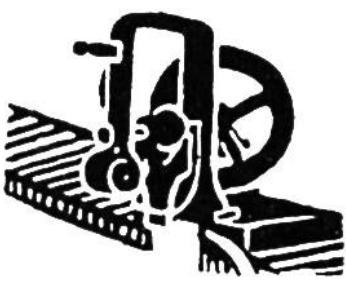
1846. Nachdem 100 Jahre lang von vielen Erfindern Versuche zum Bau von Nähmaschinen gemacht worden waren, konstruierte der Amerikaner Elias Howe die erste wirklich brauchbare Nähmaschine. Er ging von den Arbeiten Hunts und Thimonniers aus und erfand die Nadel mit dem Öhr an der Spitze, und die Anwendung des Schiffchens.
