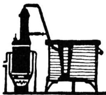
1834. Eisemaschine mit Äther vom Engländer Perkins gebaut. Eisemaschine durch Verdunstung von Ammoniak 1860 von dem franz. Ingenieur Carré erfunden, eine Erfindung von unberechenbarem Wert für die Nahrungsmittel-Industrie.
