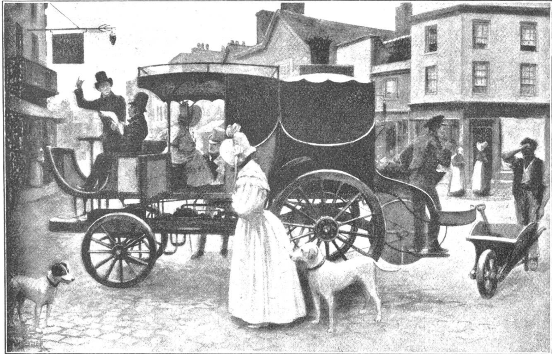
Die Verwendung von Dampfmaschinen als Verkehrsmittel wurde vor nahezu hundert Jahren in England Mode. Der Erfindergeist schuf die merkwürdigsten Fahrzeuge; eines der zweckdienlichsten war der Wagen von Macerone und Squire (eines ehemaligen Arbeiters von Gurney). Dieser Wagen fuhr mit einer Geschwindigkeit von 30 km in der Stunde.
