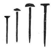
1785. Die erste Maschine zur Sabritation von Eisennägeln wird durch den Engländer Thomas Clifford gebaut. 1811 ersindet der Engländer James White eine Maschine zur Sabritation von Nägeln aus Draht (Drahtstifte), die im Gegensatz zu den frühern, kantigen Nägeln einen runden Schaft haben.
