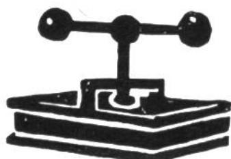
1780. Kopierpresse zum Abklatschen von Briefen auf nasses Briefpapier, unter Benutzung einer dicken Tinte, von dem Schotten James Watt, dem Erfinder der modernen Dampfmaschine, erfunden und patentiert.
