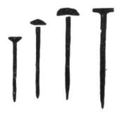
1785. Die erste Maschine zur Sabritation von Eisens nägeln wird durch den Engsländer Thomas Clifford gebaut. 1811 erfindet der Engländer Jasmes White eine Maschine zur Sabritation von Nägeln aus Draht (Drahtstifte), die im Gegensatz zu den frühern, kantigen Nägeln einen runden Schaft haben.
