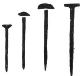
1785. Die erste Maschine zur Fabrikation von Eisennägeln wird durch den Engländer Thomas Clifford gebaut. 1811 erfindet der Engländer James White eine Maschine zur Fabrikation von Nägeln aus Draht (Drahtstifte), die im Gegensatz zu den früheren, lantigen Nägeln einen runden Schaft haben.
