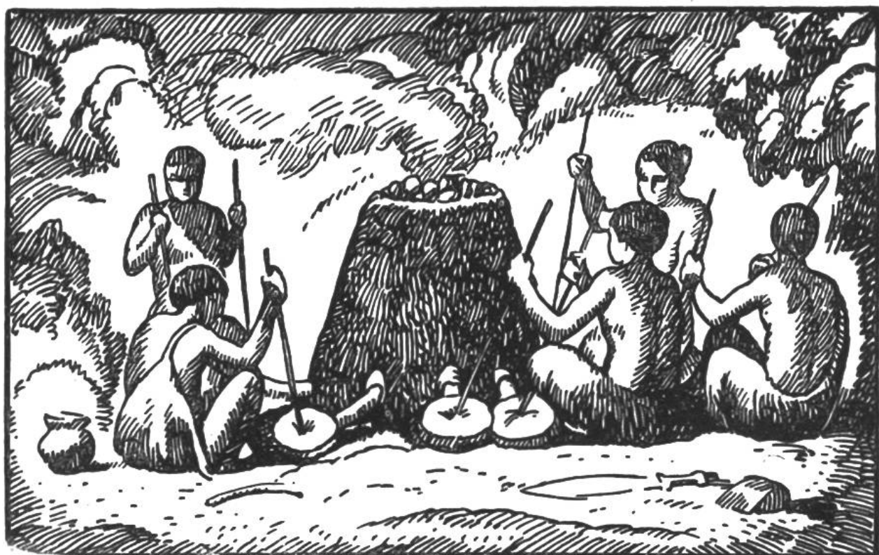
Erzgewinnung in primitivem, mit Blasebälgen angefachtem Ofen.
