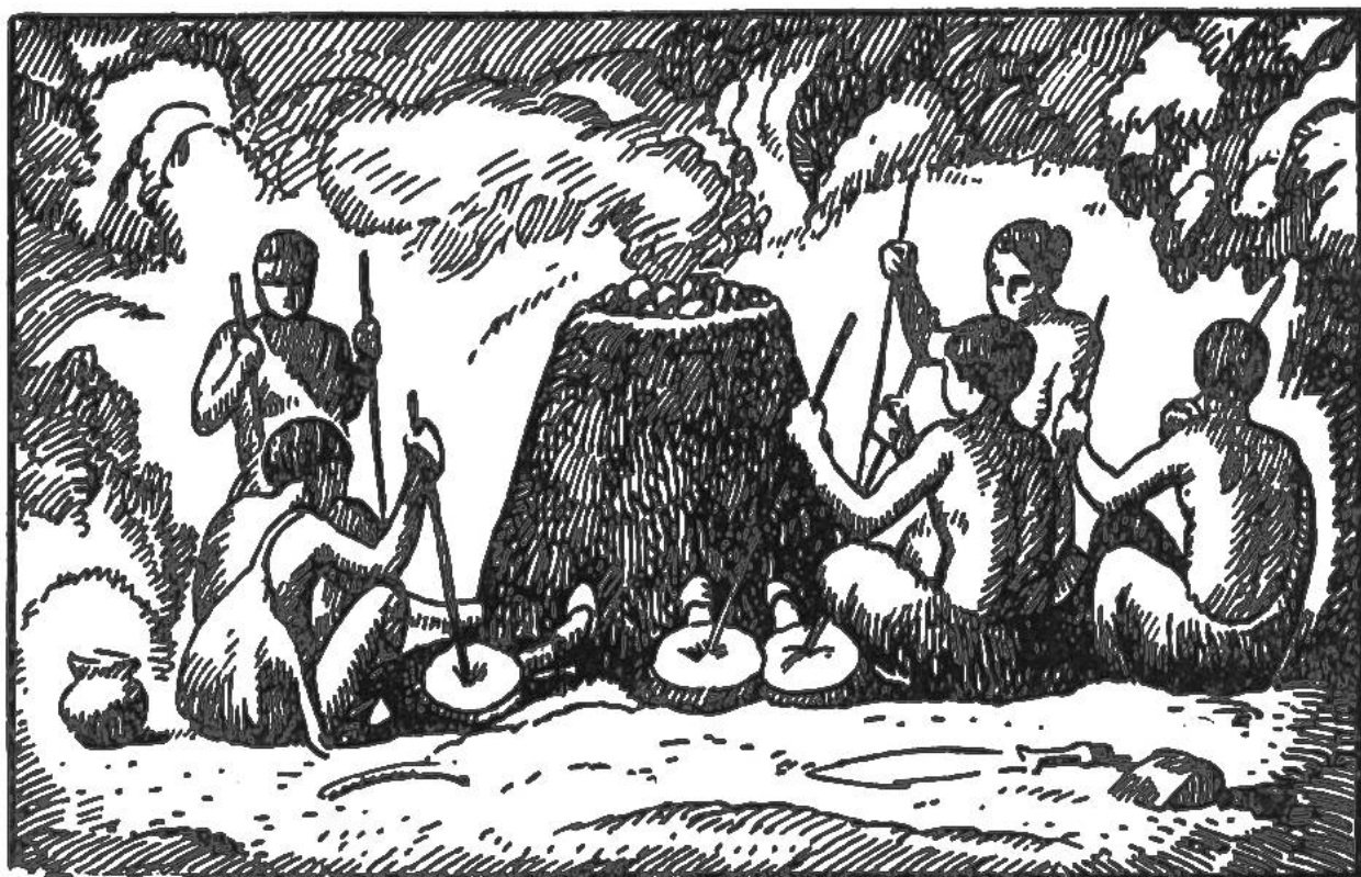
Erzgewinnung in primitivem, mit Blasebälgen angefachtem Ofen.
