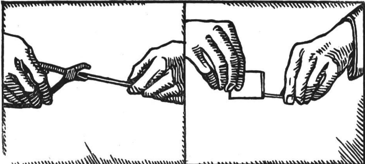
Ein eigenartiges Feuerzeug kam später in Gebrauch. Es bestand aus einem aufgerollten Papierchen, das an dem einen Ende mit Chemikalien behandelt war. An diesem Ende befand sich auch, im Papier eingerollt, ein winziges, säuregefülltes Glaskügelchen. Wurde dieses mit einer Zange gebrochen, so entzündeten sich die Chemikalien.
