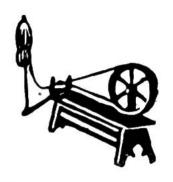
Um 1480. Die ersten SPINN-RÄDER verdrängen den seit uralter Zeit gebrauchten Spinnrocken. 1530 erfindet Jürgen in Wolfenbüttel bei Braunschweig die Tretvorrichtung am Rade.
