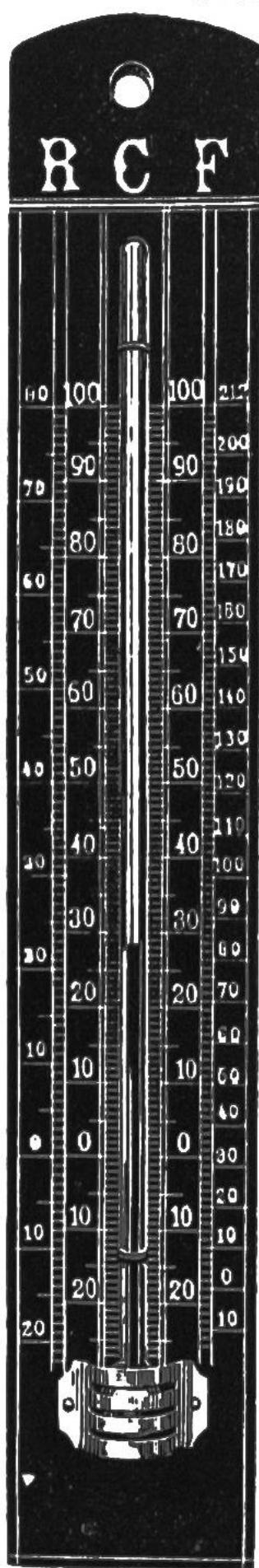
Das Wort Thermometer ist griechisch und heisst deutsch Wärmemesser. Das Thermometer dient zur Bestimmung des Wärmezustandes (Temperatur). Wärme dehnt die Körper aus, Kälte zieht sie zusammen. Das Thermometer misst, um wieviel sich gewisse Körper (meistens Quecksilber, das in einem Gefäss mit Haarröhrchen eingeschlossen ist) infolge der Temperatureinflüsse ausdehnen oder zusammenziehen und bestimmt dadurch den Grad der bestehenden Wärme oder Kälte.
