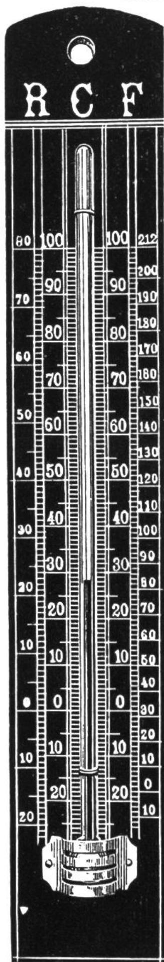
Das Wort Thermometer ist griechisch und heisst deutsch Wärmemesser. Das Thermometer dient zur Bestimmung des Wärmezustandes (Temperatur). Wärme dehnt die Körper aus, Kälte zieht sie zusammen. Das Thermometer misst, um wieviel sich gewisse Körper (meistens Quecksilber, das in einem Gefäss mit Haarröhrchen eingeschlossen ist) infolge der Temperatureinflüsse ausdehnen oder zusammenziehen und bestimmt dadurch den Grad der bestehenden Wärme oder Kälte.
