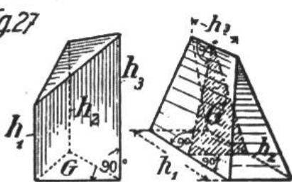
Schiefabgeschnittenes Prisma:Flächeninhalt des senkrechten Querschnittes =  $G$ ,
