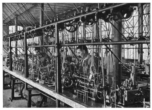
Ein Maschinensaal i. d. berühmten Uhrenfabrik Zenith A.-G., Le Locle. Die ungefähr 3700 versch. Arbeiten zur Anfertigung einer mod. Präzisionsuhr werden heute grossenteils durch Automaten ausgeführt.
