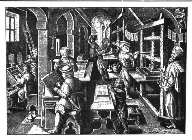
BUCHDRUCKEREI ZU ENDE DES 16. JAHRHUNDERTS. Die rechts auf dem Bilde sichtbare Presse musste für den Druck eines jeden Bogens von Hand zu- und aufgeschraubt werden. Der schräge Setzkasten, der die Buchstaben enthält, sieht noch heute in den Druckereien genau gleich aus. Umfangreiche Arbeiten werden jetzt vielfach auf der schreibmaschineähnlichen Tastatur der Satzgiessmaschine geschrieben und von der Maschine fortlaufend in Metall gegossen (ca. 5000 Buchstaben in der Stunde).
