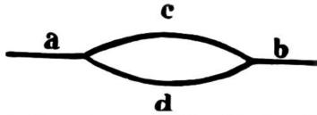
Der erste Zugführer fährt von a über c nach b, lässt jedoch 4 Wagen auf dem Seiten-Strange stehen. Dann fährt er mit den übrigen 16 Wagen über den Schienenstrang d wieder nach a und noch so weit zurück, dass der zweite Lokomo-
