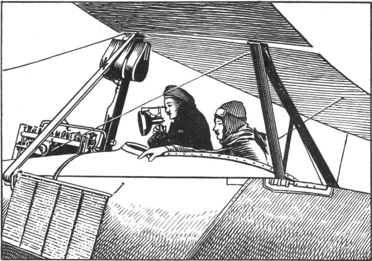
Abb. 4 Der Flieger teilt seine Beobachtungen mit Hilfe des Donath'schen Signalspiegels einer Erdstation mit.
