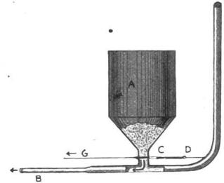
Abb. 1 Apparat zur Erzeugung von Russwolken
