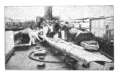
Torpedolancierrohr. Zum Abfeuern sind auf den Schiffen besondere Torpedoausstossrohre eingebaut.
