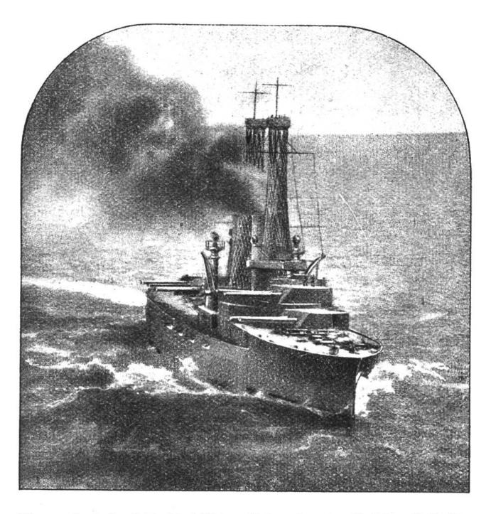
Ein amerikanisches Schlachtschiff, kenntlich an den eigentümlichen Stahlgittertürmen, fährt mit Volldampf und in Gefechtsbereitschaft dem Feind entgegen. Das Deck ist abgeräumt; die Panzertürme sind alle nach derselben Seite gedreht, um eine Breitseite abzufeuern.
