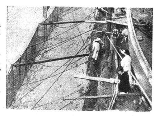
Panzerschiffe suchen sich durch ein Netz, das um den Schiffskörper hängt, vor den Torpedos zu schützen; die Torpedos sind in neuester Zeit mit Scheren ausgerüstet, welche die Netze zerschneiden sollen.
