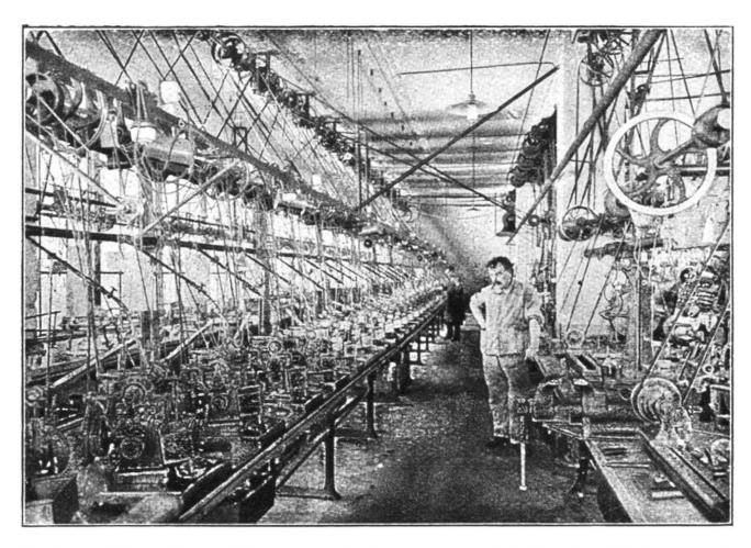
Moderne Uhrenfabrik: Blick in den Saal m. d. automatischen Maschinen, z. Ausschneiden d. Schrauben u. Triebfedern, i. d. weltbekannten Uhrenfabrik Zenith.
