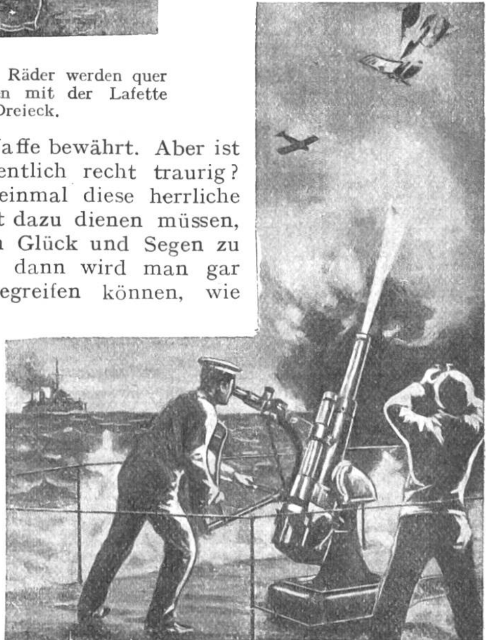
Ballonabwehrkanone auf einem deutschen Unterseeboot.
