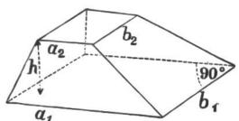
Sind  $a_1$ ,  $b_1$  die Kanten der untern,  $a_2$ ,  $b_2$  diejenigen der obern Endfläche eines Obelisken von der Höhe h, so ist sein Rauminhalt:
